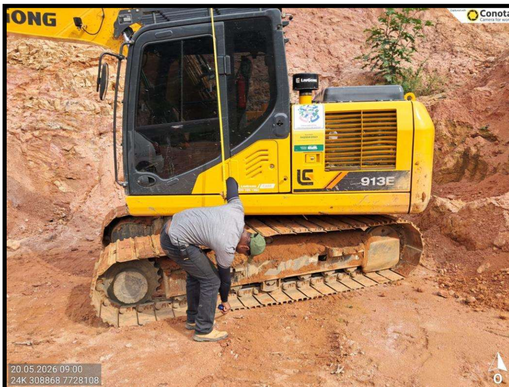
Fig. 02. Comparativo da altura da escavadeira giratória, apresentando 5,00 metros. Já a altura da linha férrea 4,30 metros.
